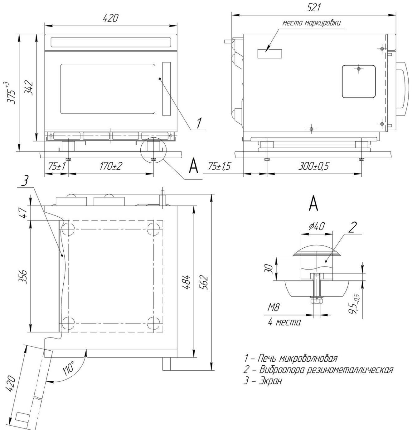
**Рисунок 1.** Габаритные и установочные размеры печи
