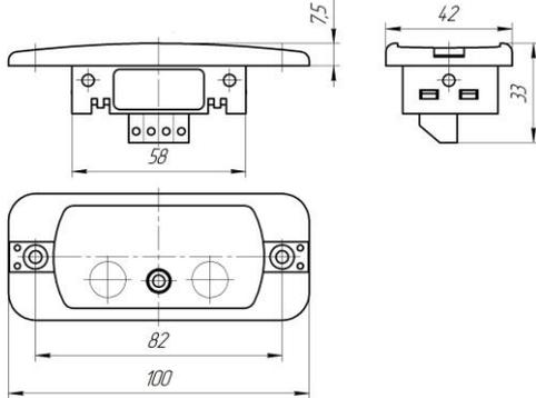
Рис. 1а Панель регулирования громкости ПРГ-2.011
