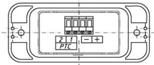
Рис. 1б Панель регулирования громкости ПРГ-2.011 Вид сзади
