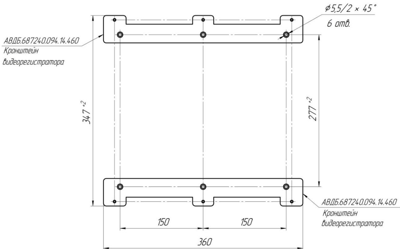
**Рис.2** Монтажные размеры установки кронштейнов видеорегистратора ВР-3
