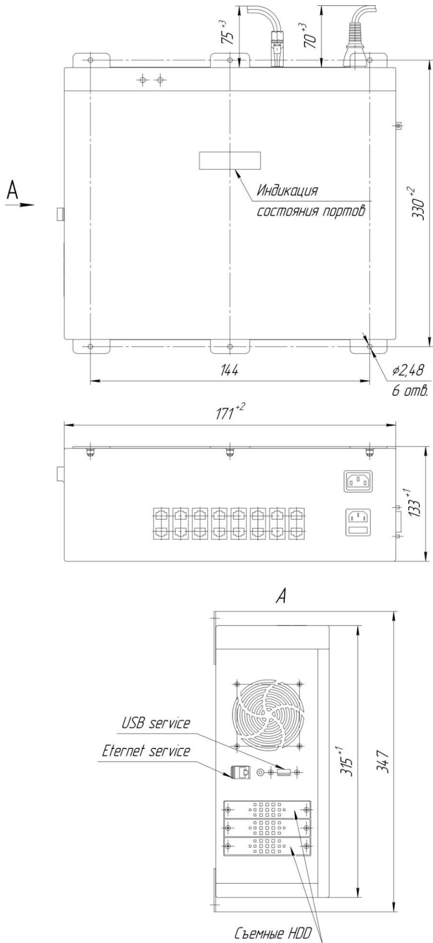
**Рис.1** Габаритные и установочные размеры ВР-3
