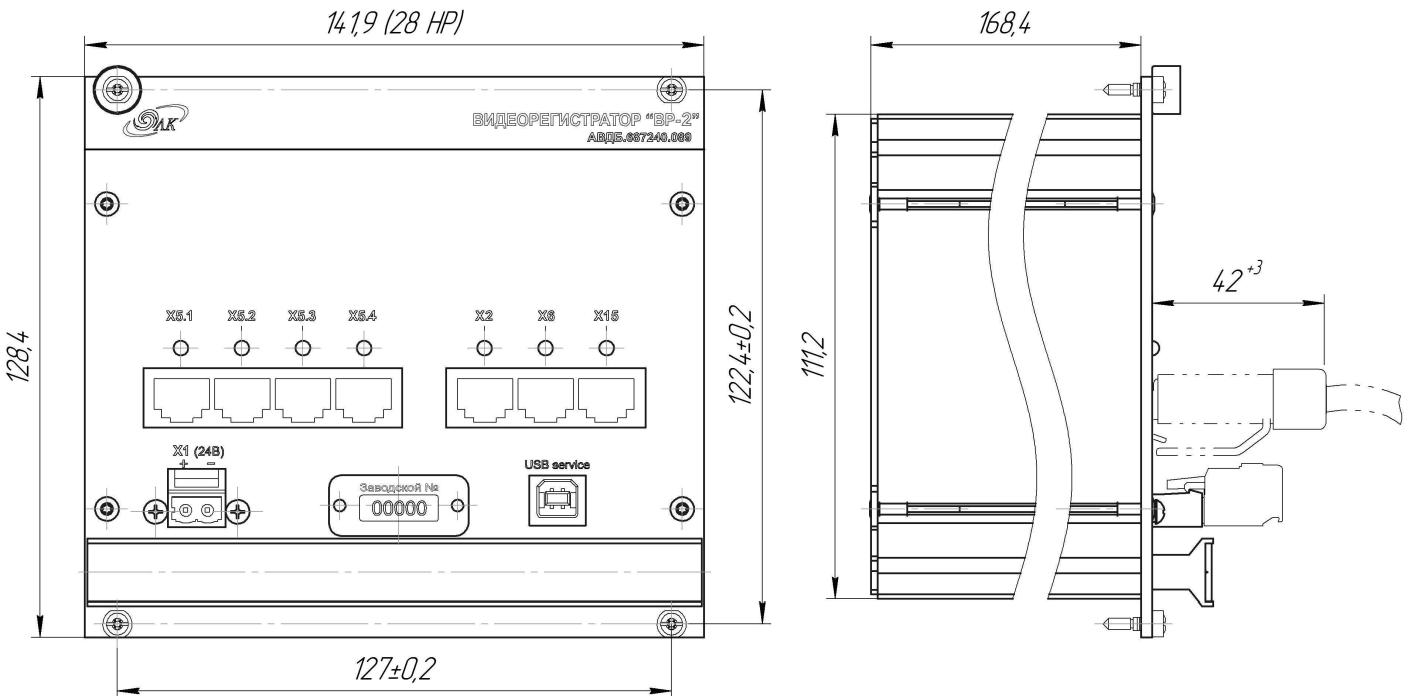
Рис.1 Габаритные и установочные размеры ВР-2
