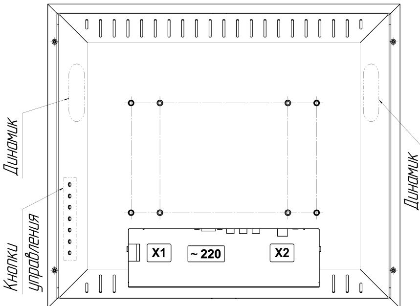
Рис. 16 Телевизор. Вид сзади.
